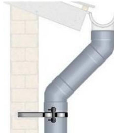
Figura N° 4.- Montante, bajante pluvial
