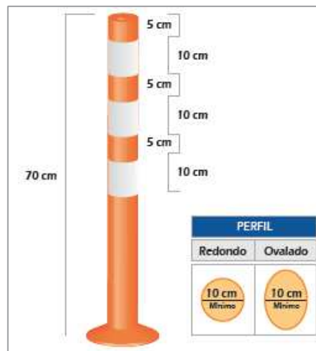
Figura 5.4 Ejemplo de un delineador simple con dimensiones.
