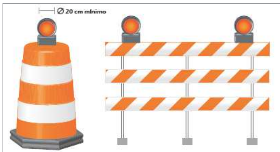
Figura 5.9 Ejemplo de barreras reforzadas con dispositivos luminosos.
